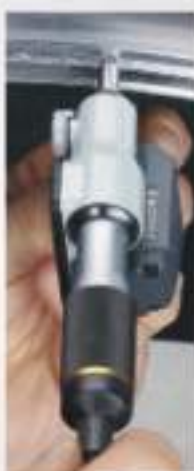
U-WAVE-T collegato a uno strumento di misura Digimatic da un cavo speciale che si adatta all'interfaccia dati di quel particolare strumento di misura.
